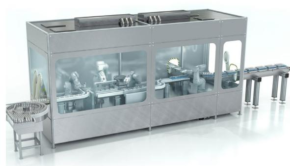
Klasse A Robotics in Isolatoren: Der Trend zu handschuhlosen Isolatoren wird den breiteren Einsatz von Sechsstrobotern für sich wiederholende und ungeplante Aufgaben fördern.
